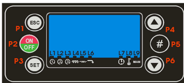
Фигура1: Електрическо/електромеханично табло за управление
