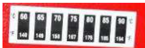
Фигура 5.14. Поглед към реверсивния (самовъзстановяващ се) термостикер за определяне на работната температура в зоната на горелката, на която е залепен – състояние при стайна температура .
