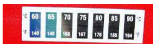
Фигура 5.15. Поглед към реверсивния (самовъзстановяващ се) термостикер за определяне на работната температура в зоната на горелката, на която е залепен – състояние при повишена температура – в диапазона 60 – 65°C .
