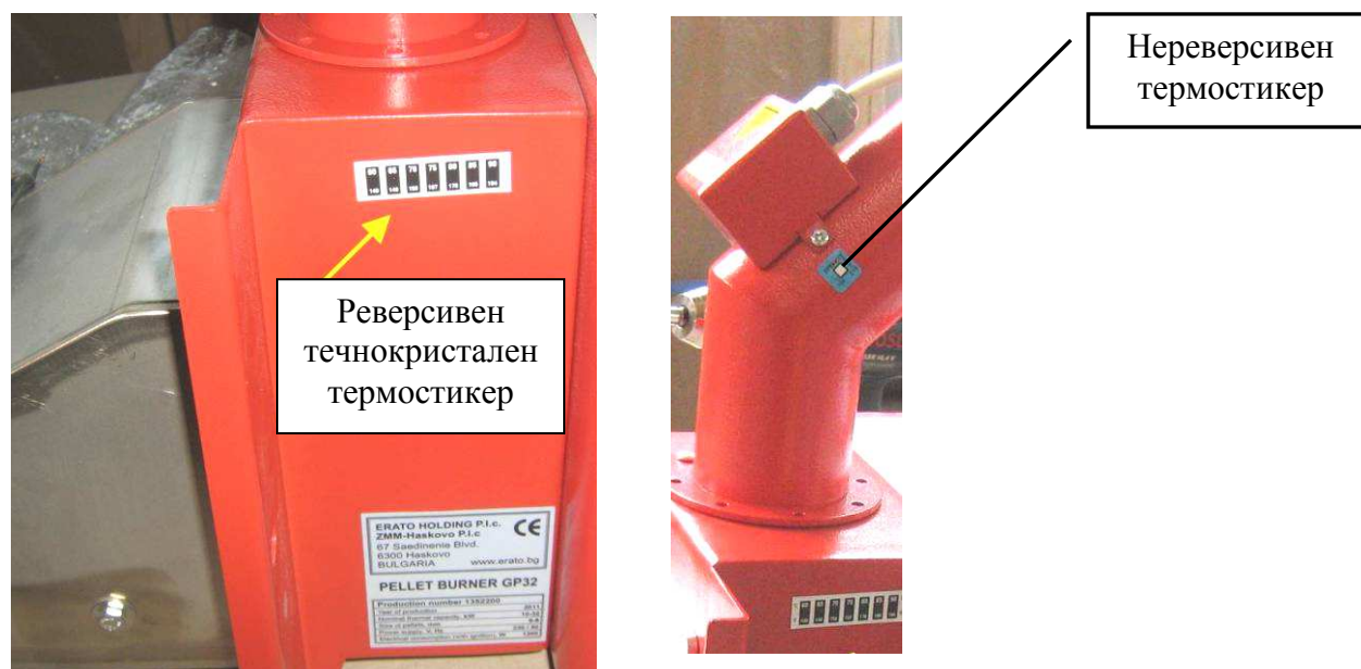
Фигура 3.4. Изглед на страната на горелката от серията “GP”, на която е залепен течнокристалния реверсивен термостикер;
