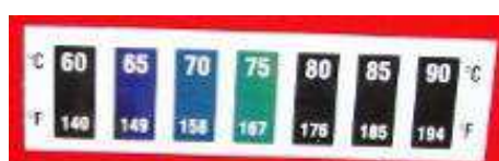
Фигура 5.15. Поглед към реверсивния (самовъзстановяващ се) термостикер за определяне на работната температура в зоната на горелката, на която е залепен – състояние при повишена температура – в диапазона 60 – 65°C .
