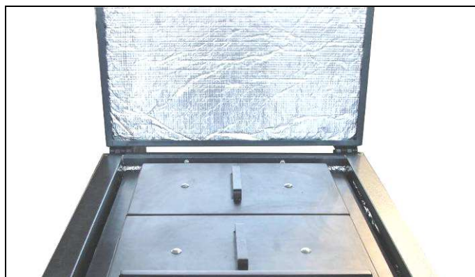
Фигура 5.11. Поставени направляващите капаци на дымоходния тракт на котела.
