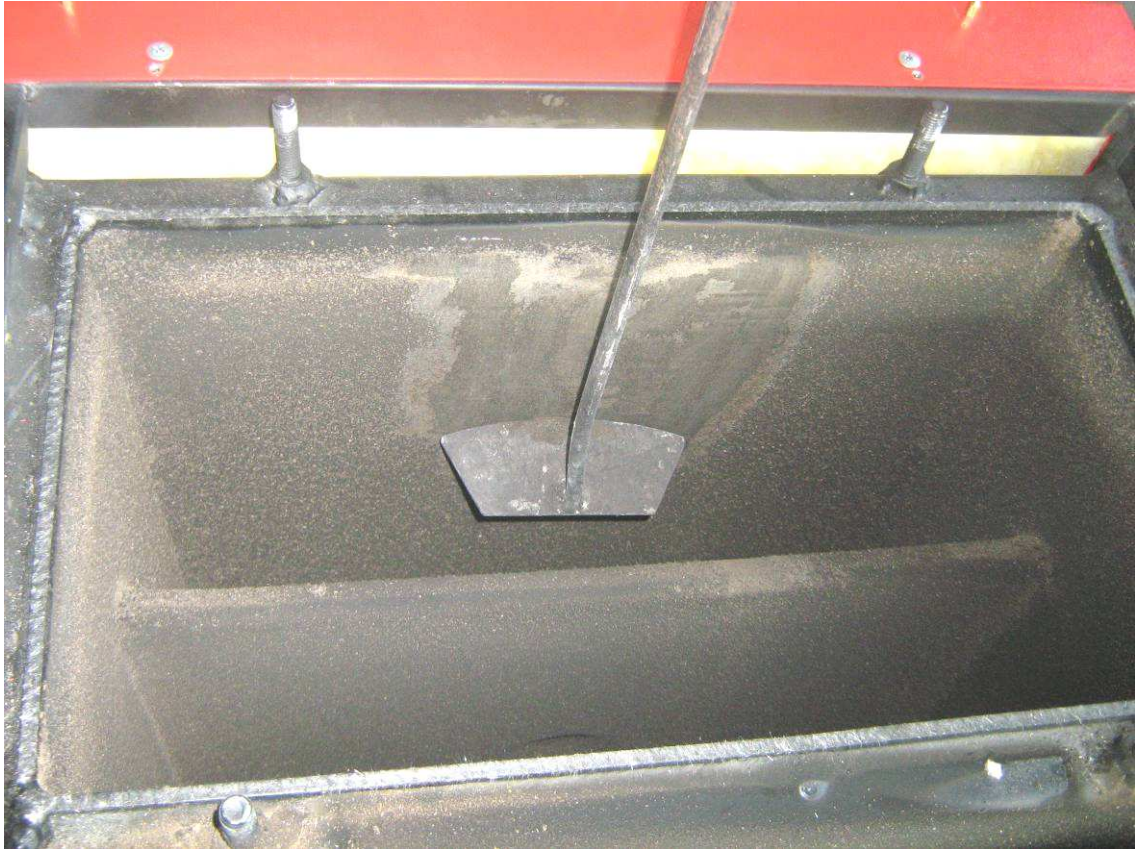
Фигура 2.4. Почистване на пепелния остатък, натрупан по нагревните повърхности на котела;
