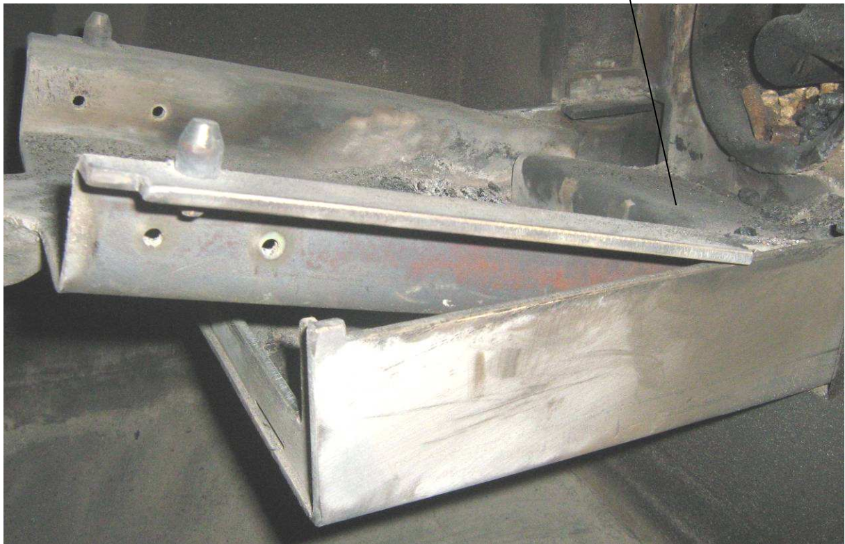
Фигура 2.14. Демонтиране на скарата на специализираната горелка;
