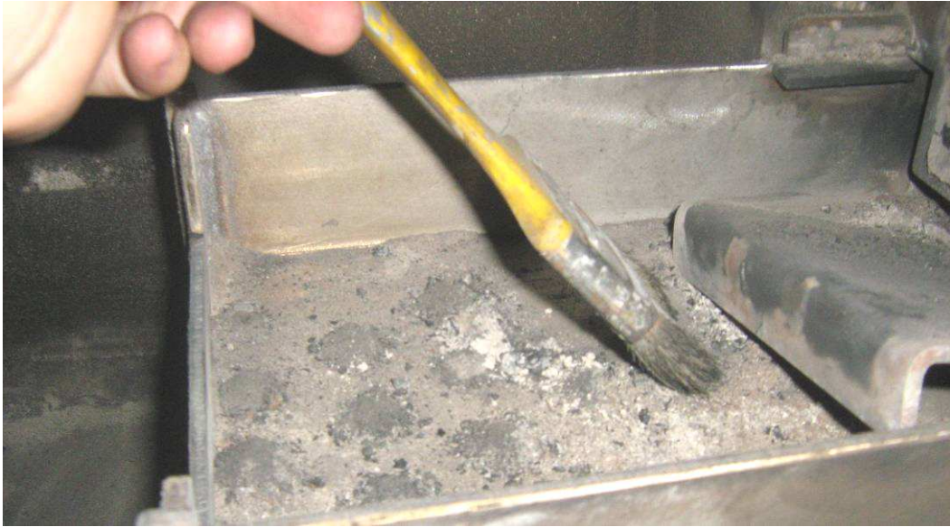
Фигура 2.15. Почистване на пепелния остатък, пропаднал под скарата на специализираната горелка;
