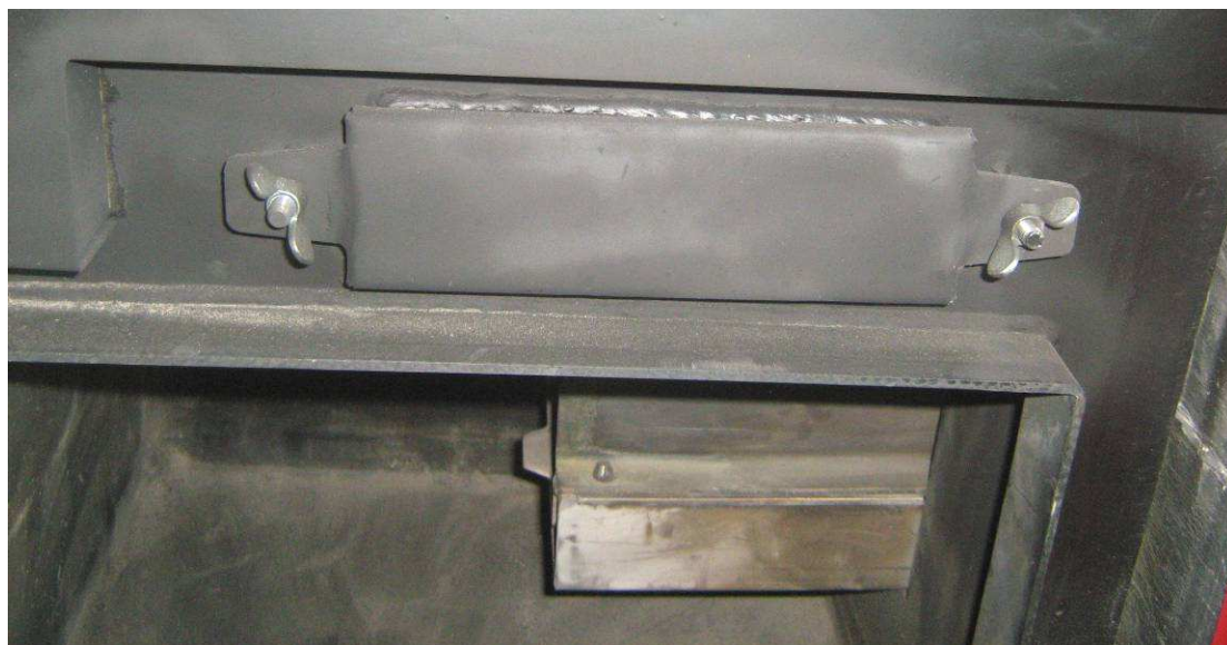
Фигура 2.9. Капачка, затваряща обема за обръщане на хода на димните газове (преходът от втория към третия ход на димоходния тракт на котела);
