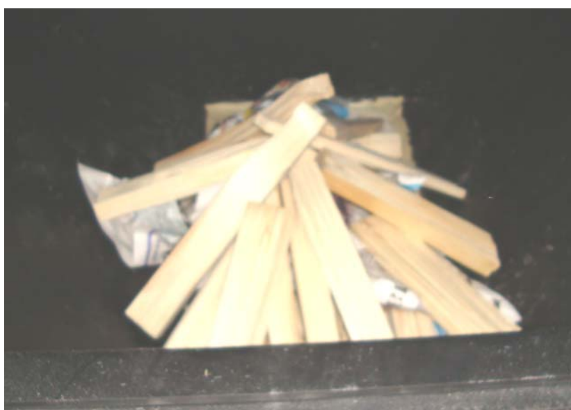
Фигура 5.4. Подреждане на началното количество гориво, необходимо за разпалване на котела;
