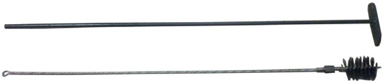
Фигура 5.12. Инструменти (гребло и четка) за почистване на котела от пепелния остатък;
