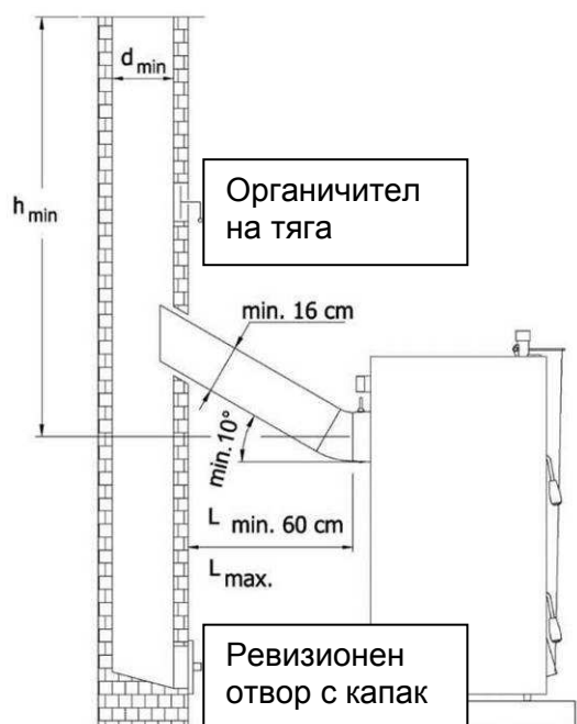
Фигура 20. Препоръчителни размери на комината система
