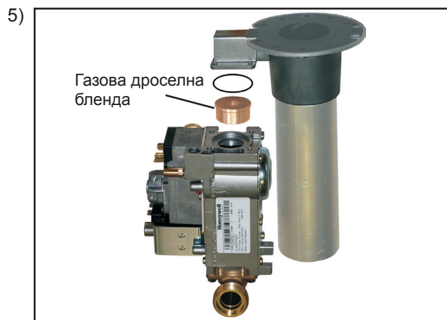
5) Премахнете вградената газова дроселна бленда и заменете с газова дроселна бленда за нов тип газ (съгласно таблица стр. 25) .
