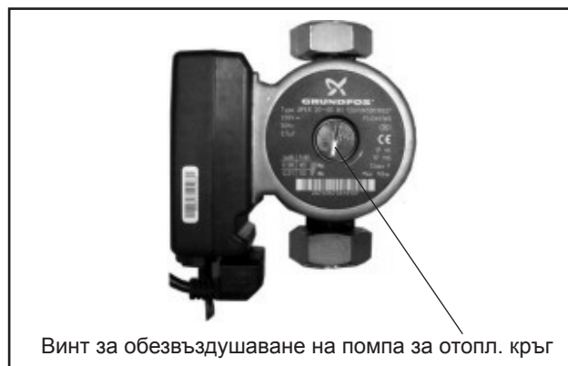
Снимка: Обезвъздушаване на помпа за отопл. кръг
