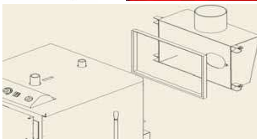
Схема на димосборната камера, когато е свалена от котела
