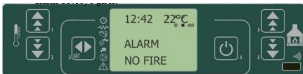
Фигура 7.3. Алармено съобщение при невъзможност за запалване.
