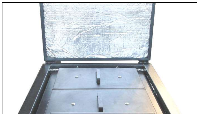
Фигура 5.11. Поставени направляващите капаци на димоходния тракт на котела.
