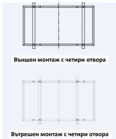
Фигура 12: Монтажните релси трябва да са разположени перпендикулярно на дългата рамка
