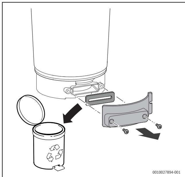
Фиг. 66 Отваряне на ревизионния отвор
